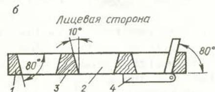
Способы разметки трапециевидных шипов и проушин:
