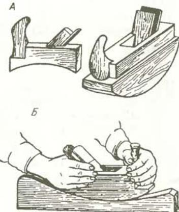
А — обычный горбач с деревянной колодкой, Б — прием работы
