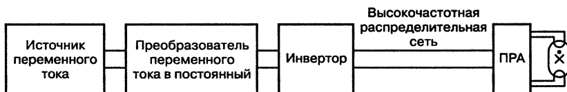
Рис. 5.8. Структурная схема осветительной установки с питанием ламп на повышенной частоте
