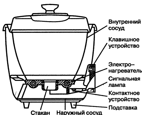
Рис. 7.8. Конструкция электрорисоварки
