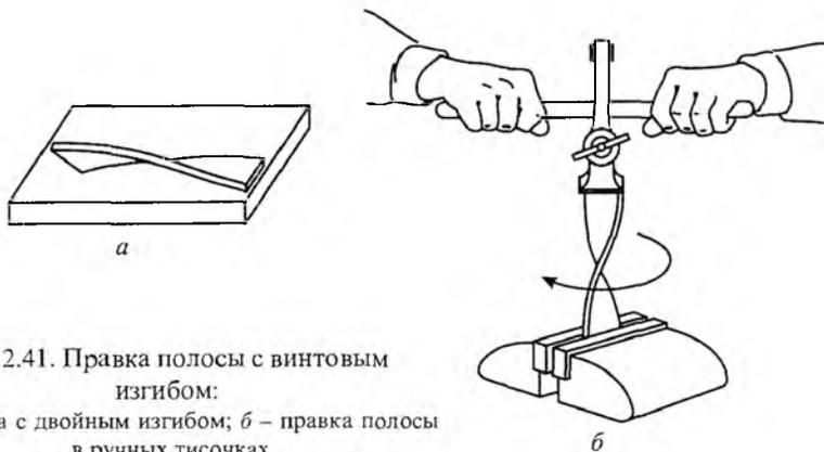
Рис. 2.41. Правка полосы с винтовым изгибом:
