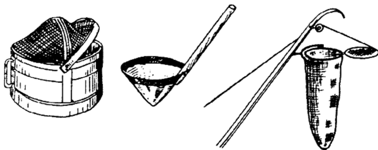
Рис. 25. Инвентарь, используемый при роении пчелиных семей: а – роевня Бутлерова; б – черпак для огребания роя; в – роесниматель
