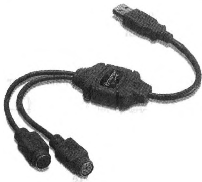
Рис. 4.2. Переходник с USB на PS/2 и припаивание разъема на рабочее место.
